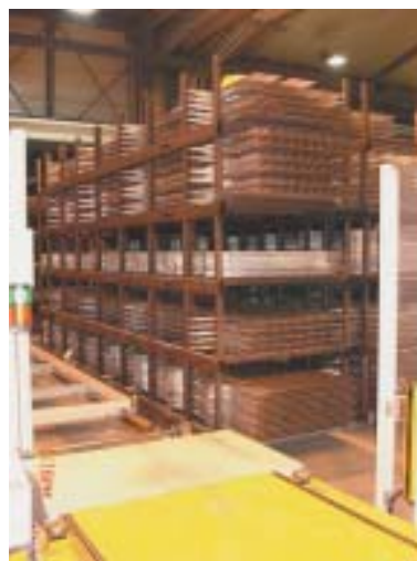
Fünffach-Blockturm im Automatikkran-Blocklager
