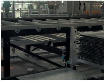
Automatischer Spacertransport, von links: Rückführband, Übergabe, Transporteinrichtung ins Erdgeschoss Automatic spacer transport, from left: transverse conveyor, collecting station, transport unit to ground level
