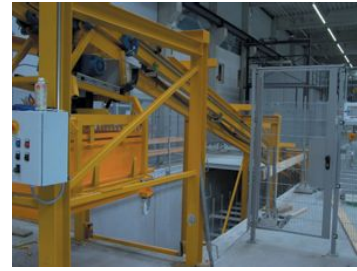
Automatischer Spacertransport, von links: Rückführband, Übergabe, Transporteinrichtung ins Erdgeschoss Automatic spacer transport, from left: transverse conveyor, collecting station, transport unit to ground level
