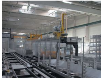
Automatischer Spacertransport, von links: Rückführband, Übergabe, Transporteinrichtung ins Erdgeschoss Automatic spacer transport, from left: transverse conveyor, collecting station, transport unit to ground level
