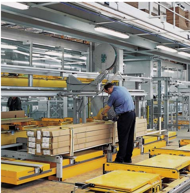
Umreifungsstation: Die Packstücke werden mit einem Semimanipulator umreift.
