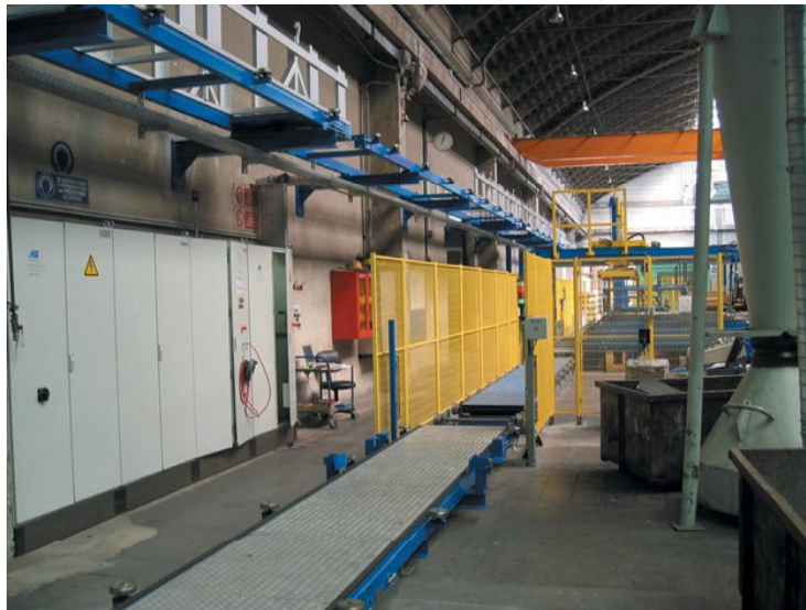
Rücklauf der Leerkörbe in drei Meter Höhe über Flur
