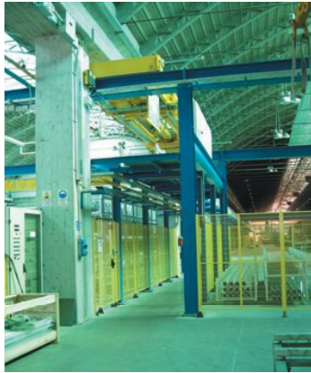
Leerkorb-Rücktransport mittels Automatikkran und aufgeständerter Rollenbahn
