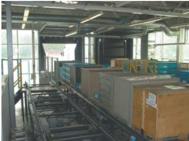
Wareneingang: Die angelieferten Ladungsträger werden über Barcodes erfasst und ins System eingebucht
